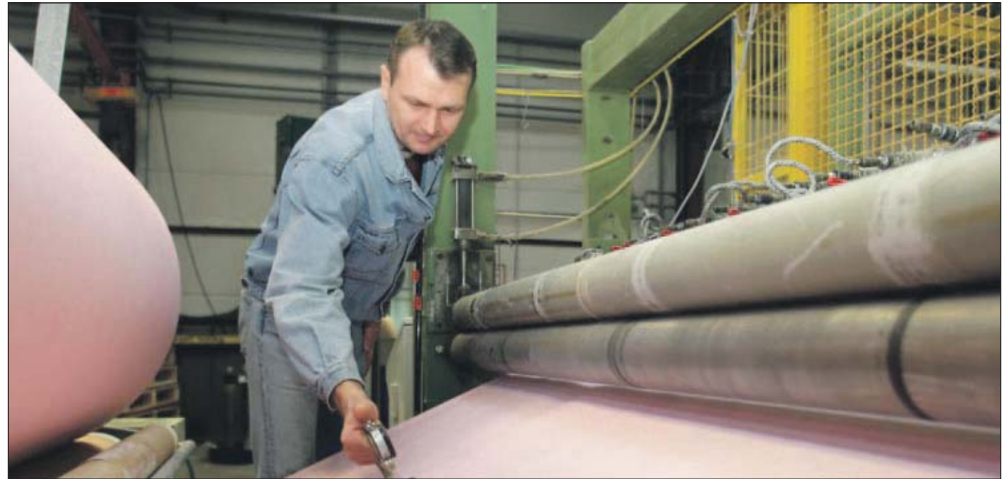
Milimeter-Arbeit: Juri Emeljanov von der Ramsteiner Firma Dittrich & Söhne ermittelt die Dicke des Stoffs, der zu Vlies verarbeitet wird.
